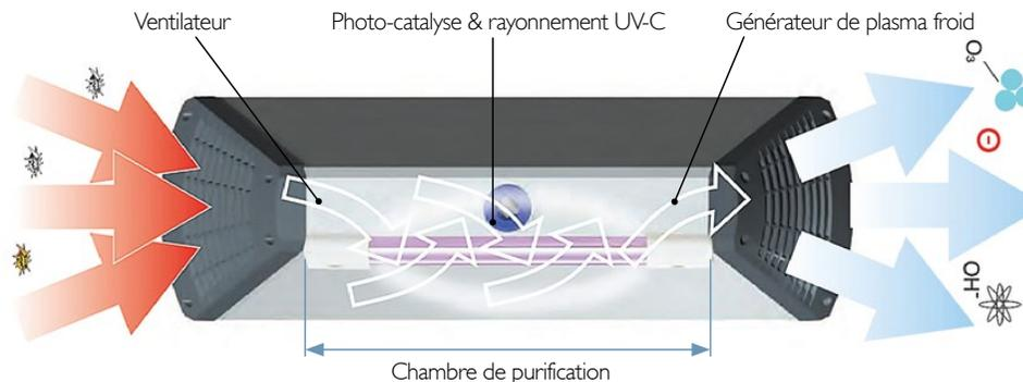
Cette technologie ne nécessite pas de faire passer l'intégralité du volume d'air à l'intérieur du module car l'action s'effectue surtout à l'extérieur. C'est l'air épuré, sortant du module et chargé de plasma, qui va ainsi circuler dans les vestiaires et détruire les virus, bactéries, champignons, les polluants nocifs etc...
