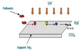
L'oxydation photocatalytique décompose les Composés Organiques Volatils (COV) tels que le méthane, le benzène...
