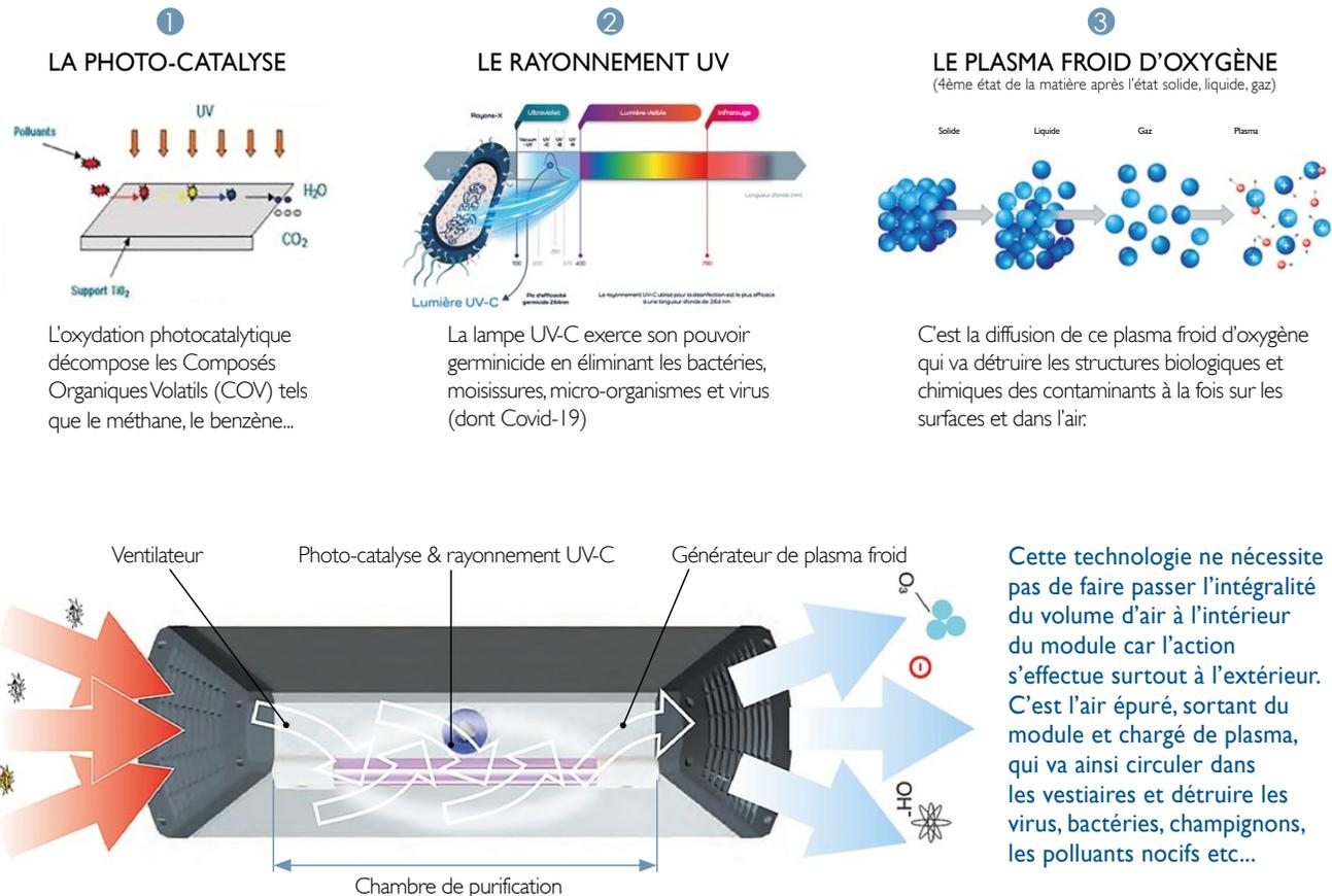
Cette technologie ne nécessite pas de faire passer l'intégralité du volume d'air à l'intérieur du module car l'action s'effectue surtout à l'extérieur. C'est l'air épuré, sortant du module et chargé de plasma, qui va ainsi circuler dans les vestiaires et détruire les virus, bactéries, champignons, les polluants nocifs etc...
