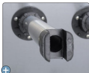
Séchage par circulation d'air chaud à l'intérieur des chaussures
