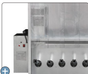
2 moteurs électriques pour un séchage efficace des EPI
