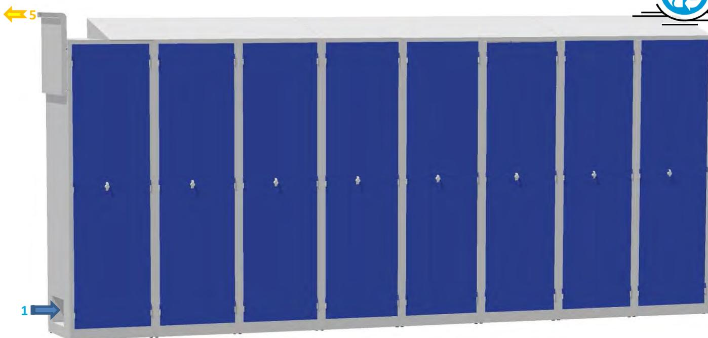
1- Prise d'air extérieure, aspirée, filtrée et chauffée par un moteur intégré. L'air chaud est distribué par les sorties de base 2 et les supports chaussures 3. Evacuation de l'air par surpression dans la gaine 4 sous l'étagère vers la sortie extérieure 5.
